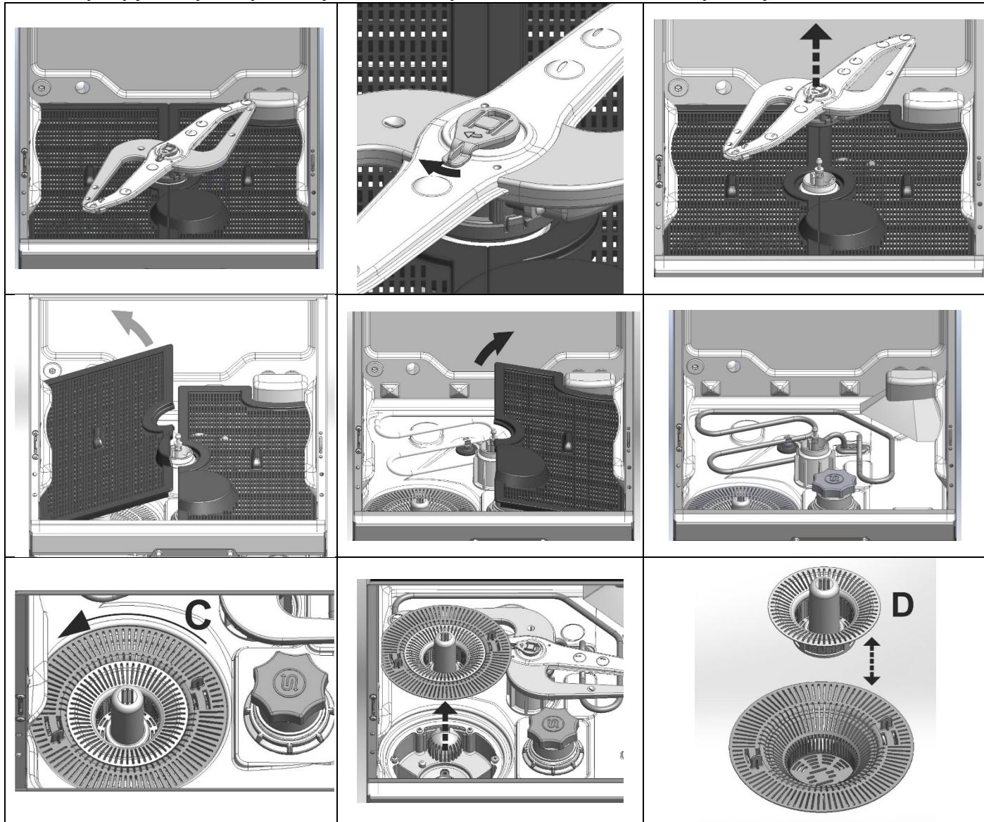
Процедура демонитрования фильтров с двумя фильтрующими элементами:
