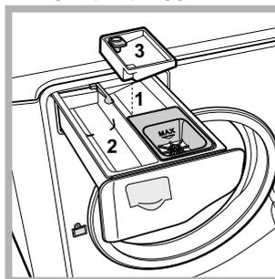
Циклдің басында көп мөлшерде кірді және ұзақ уақыт пайдалану арқылы функция оңтайлы кір жууды қамтамасыз етеді. Бұл функция қиын дақтарды кетіру үшін қажет. Қосымша 3-мөлшерлеуішті 1-мөлшерлеуішке қойыңыз. Ағартқыш қойылғанда стерженнің ортасында көрсетілген
