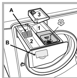
1. ячейка предварительной стирки: используйте стиральный порошок. **! Перед засыпкой стирального порошка необходимо проверить, чтобы не был установлен дополнительный дозатор 3.**
