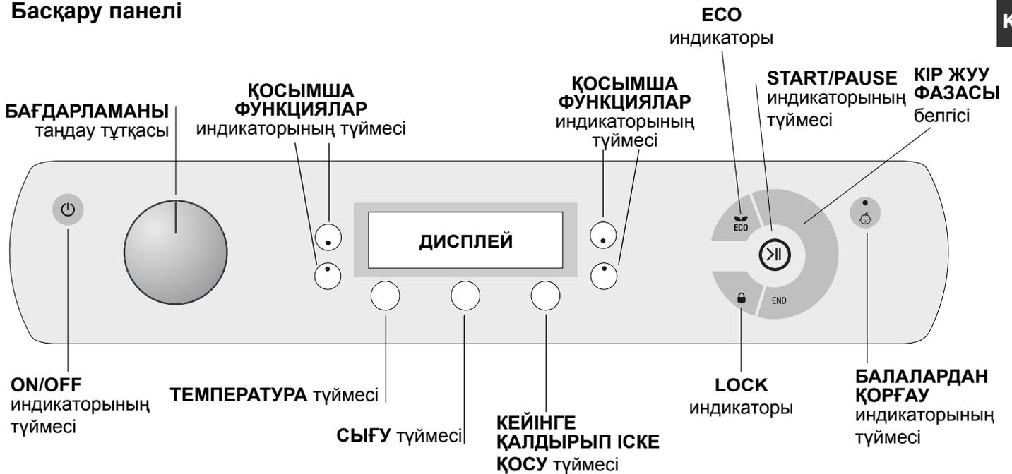
**ON/OFF** индикаторының түймесі: қосу және өшіру үшін түймені бір рет басыңыз. Жасыл индикатор машинаның қосылып тұрғанын білдіреді. Кір жуғыш машинаны қосу үшін кір жуу процесінде түймені шамамен 3 секунд басып ұстап тұру қажет. Қысқа немесе кездейсоқ басып қалғаннан машина өшіп қалмайды. Машинаны өшірген жағдайда кір жуу процесінде ағымдағы цикл жойылады.
