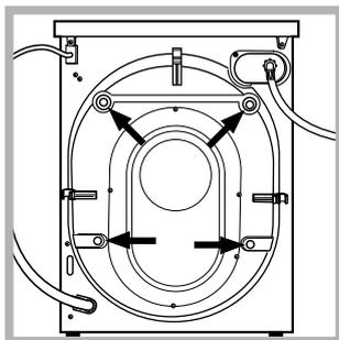
2. Тасымалдау кезінде машинаны қорғаушы 4 винтті және кір жуғыш машинаның артқы жағындағы резеңке тығындарды сәйкес тірегіш шайбамен ашыңыз (сур. қара).
