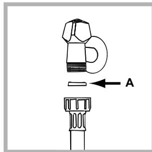
2. Вставьте прокладку А в конец водопроводного шланга и привинтите его к водопроводному крану холодной воды с резьбовым отверстием 3/4 дюйма (см. схему).
