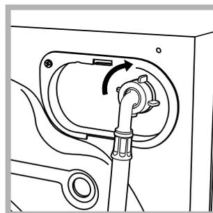
1. Су құю шлангісін артқы оң жақ жоғарғы шетінде орналасқан, су қабылдағышты винттеу арқылы кір жуғыш машинаға жалғаңыз (сур. қара).
