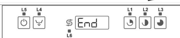
По завершению программы светодиод перестает мигать и остается включенным, на дисплее отображаются по очереди завершенная программа и "End" (пр. P2/End).
