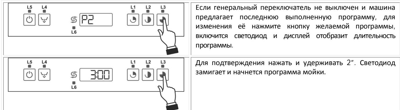
Если какая-то программа уже выполняется, её можно изменить сначала поставив машину на паузу (нажимая одну из этих кнопок на 2"), и затем выбрав желаемую программу.
